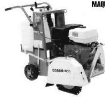
CORTADORA JUNTA DE DILATACIÓN
