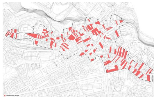
Figura 49. Desprendiments de revestiment. Plànol d'informació I-31. Font: Elaboració pròpia a partir del treball de camp (novembre 2023).
