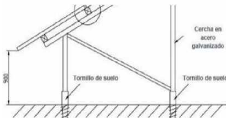
Figura 47. Panell solar fixat sense cimentació.
