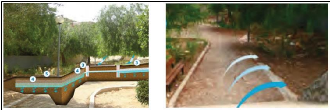
Figura 77. Fotos i esquemes de zones d'infiltració del Parc Costa de l'Ermida a Benaguasil.
