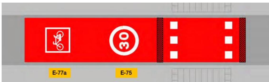
Figura 37. Exemple d'accés a carrer de zona 30: Pas de vianants elevat per reduir la velocitat dels vehicles i senyalització horitzontal
