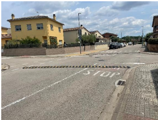
Imatge 36. Cruïlla amb dues bandes reductores prefabricades
