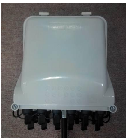
Il·lustració 19. Caixa terminal òptica (CTO) exterior (mides reduïdes).
