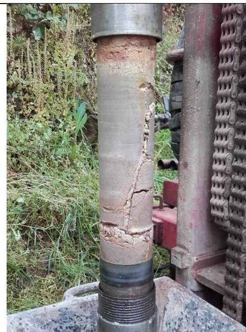
Foto 25. Detall de les esquerdes a S-2.
