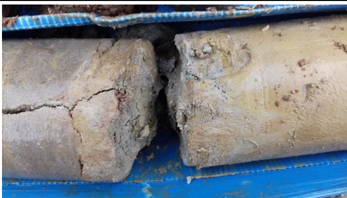
Foto 26. Detall del reompliment d'esquerdes a S-2.
