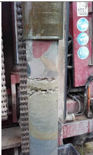
Foto 24. Detall de les esquerdes a S-1.
