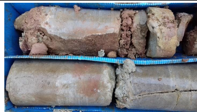
Foto 25. Detall de les esquerdes a S-2.
