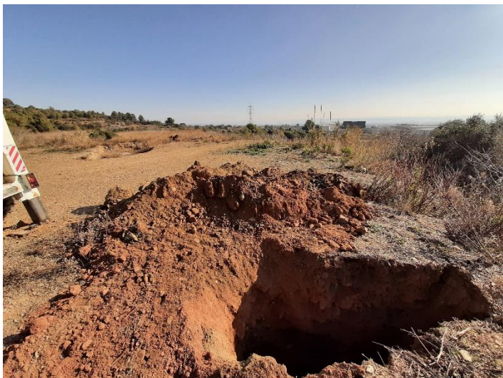
Foto 11. Material extraído de la calicata C-4.
