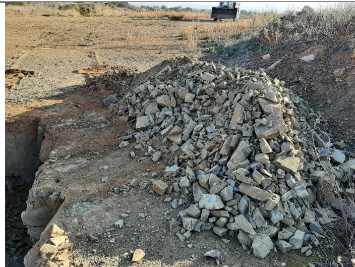
Foto 2. Material extraído de la calicata C-1.
