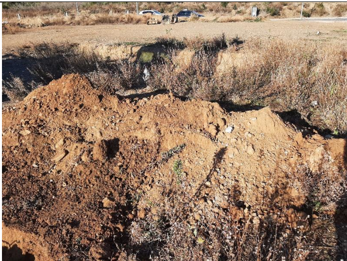
Foto 5. Material extraído de la calicata C-2.
