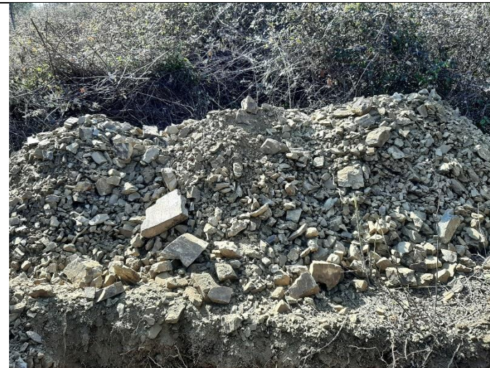
Foto 26. Material extraído de la calicata C-9.
