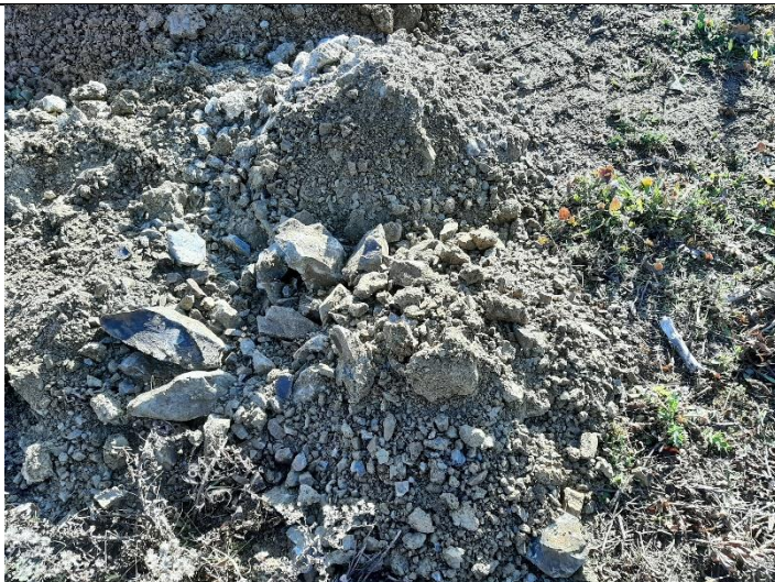
Foto 45. Material extraído en la calicata C-15 a 2,2 m de profundidad.
