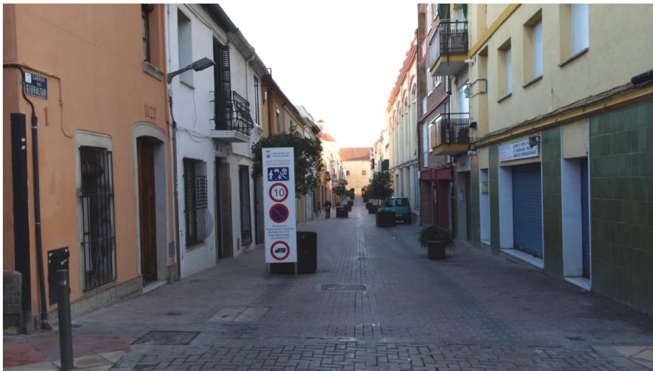
Imatge 42. Exemple de configuració de vies en plataforma única amb ús de mobiliari. Municipi de Premià de Mar
