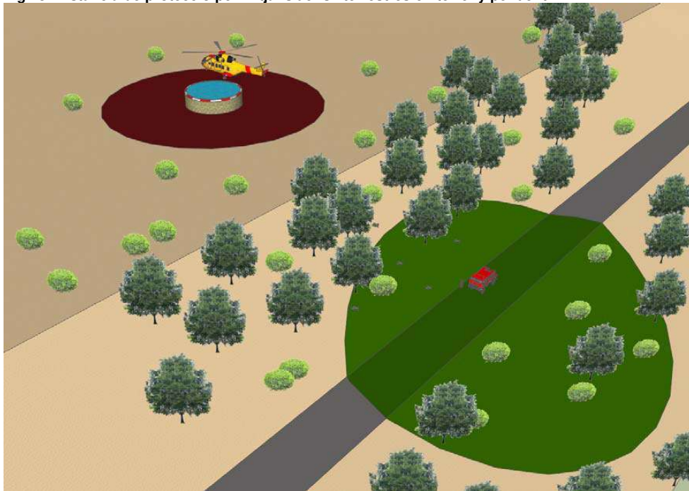
Fig 14.-Distàncies de protecció on el punt de càrrega per mitjans terrestres està apartat del punt d'aigua
