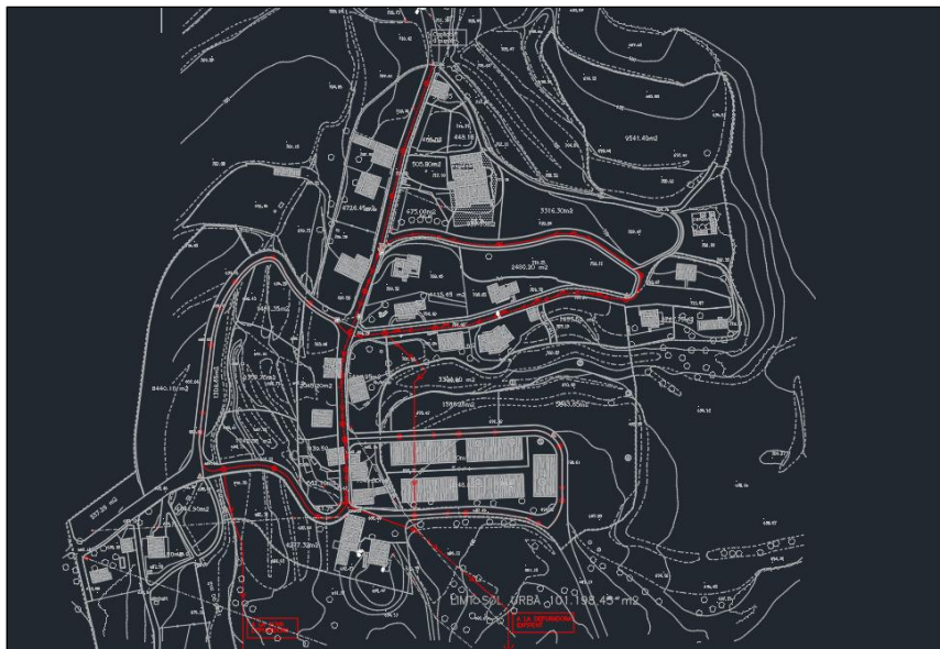
Figura 4: Exemple plànol CAD del nucli urbà de Sora que incorpora els sectors de xarxa de clavegueram coneguts i futurs
