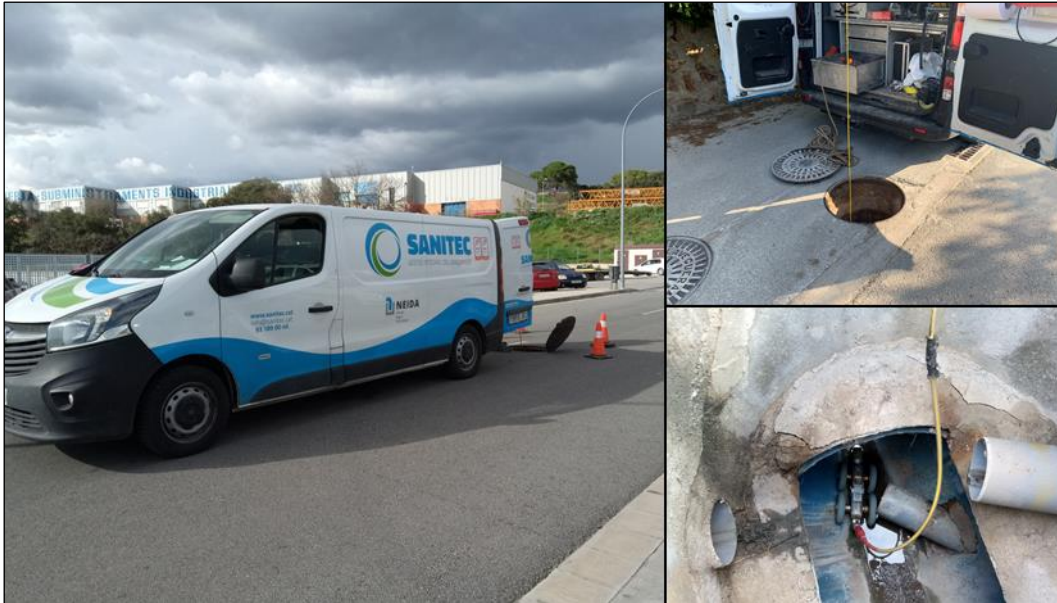
Figura 20: Furgoneta per al control i treball amb robot
