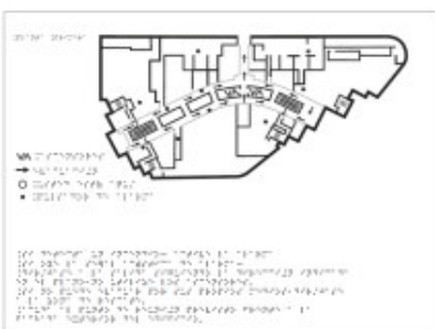
Mostra de plànol de recorregut d'evacuació accessible
