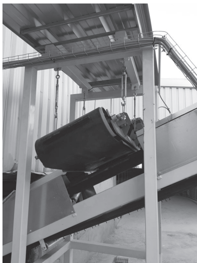
Fig.6 Detector de metales/ Extracción de materiales férricos de la biomasa
