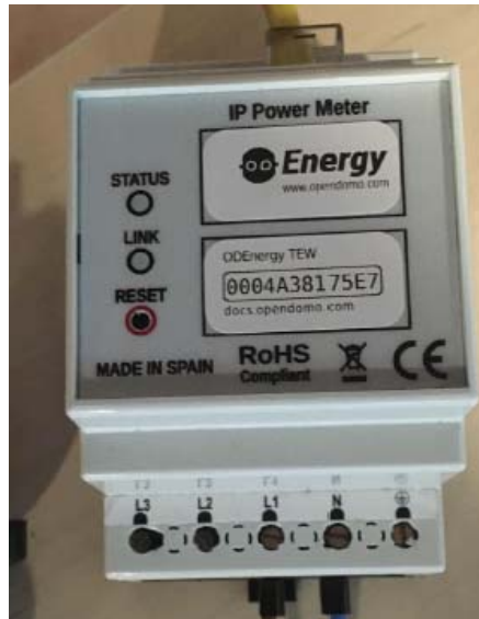
Imatge 7. Analitzador de xarxes utilitzat en les mesures.
