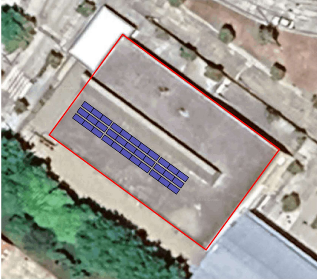
Figura 14 Disposició dels mòduls en la coberta
