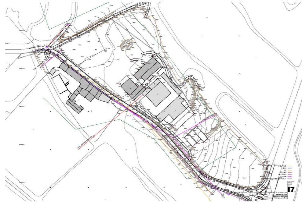
Serveis existents; Enllumenat, Gas, Aigua, Sanejament i telefonia
