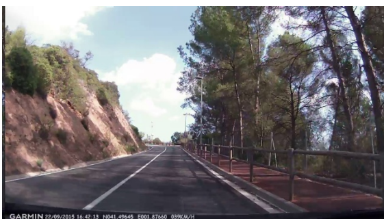
Imatge 75. Tram entre revolts on caldria un reductor per moderar les velocitats entrant a cada corba.
