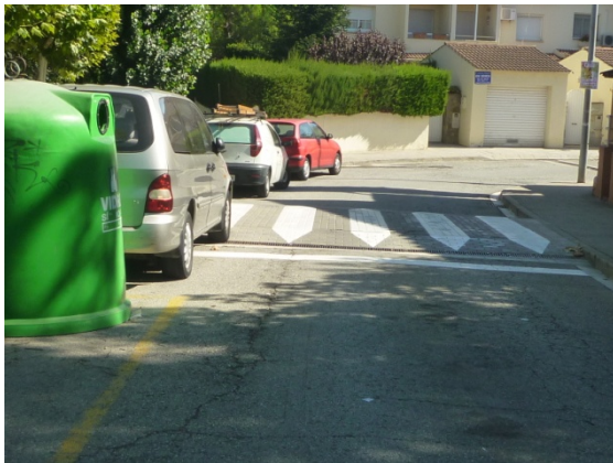
Imatge 27. Carrer de Santiago Ramón y Cajal. Malgrat l'existència del pas elevat, caldria alliberar la visibilitat en aquest punt.
