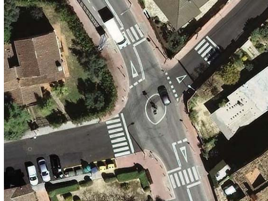
Imatge 46. Vista aèria de la rotonda de Vallserrat i els traçats que marca l'anella, pràcticament rectes.
