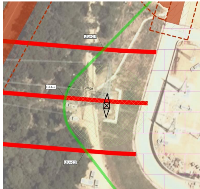
Ilustración 13 Cruzamiento tramo subterráneo con línea eléctrica aérea 400kV
