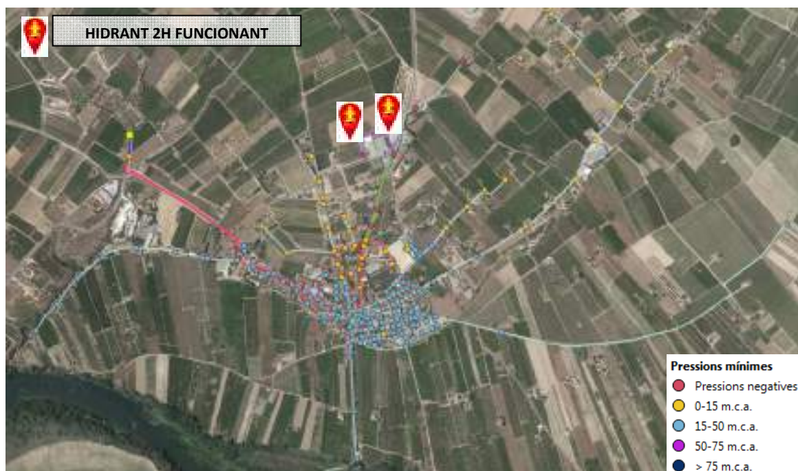
Figura 22 Mapa de pressions mínimes de la xarxa actual amb consum punta i dos hidrants en funcionament (font: pròpia).
