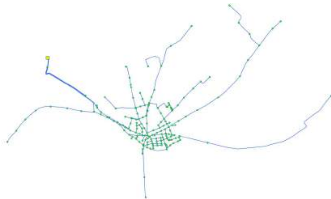
Figura 18 Model matemàtic EPANET (via GISWATER) de la xarxa d'abastament de Benissanet
