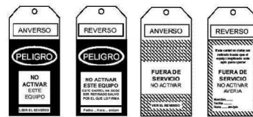
Cartells de senyalització de treballs per a la col·locació en les instal·lacions afectades.
