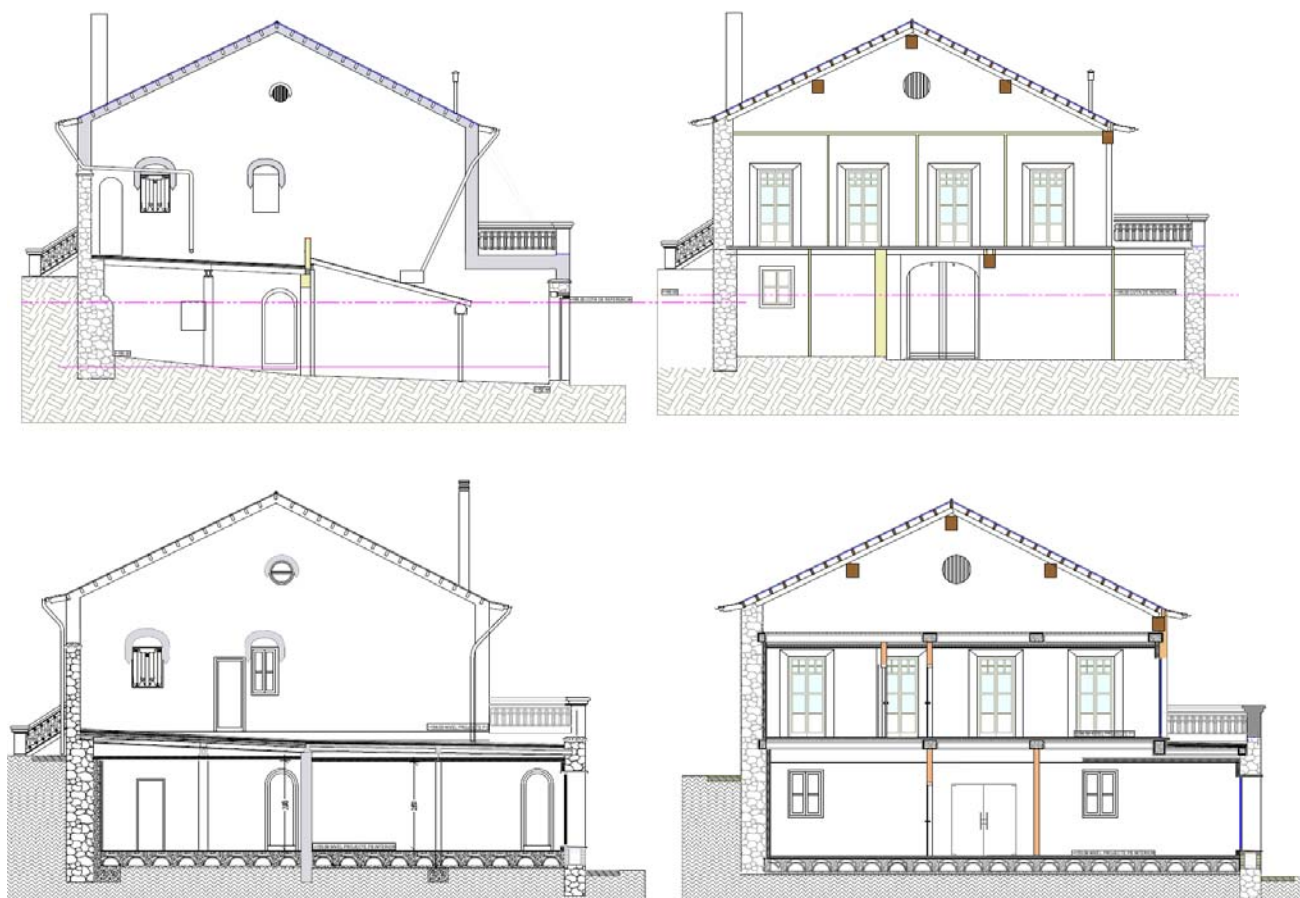
Figura 20 Esquemes sense escala dels alçats i de les seccions de la masia. A la part superior, l'estat actual. Baix, la proposta
