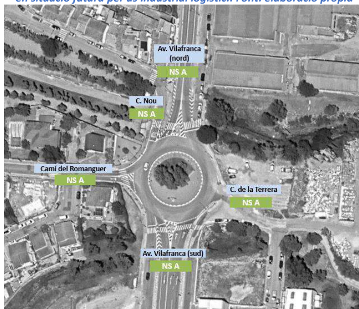
Figura 63: Nivell de servei de la rotonda de l'av. Vilafranca amb el camí del Romanguer en hora punta (8h-9h) en dia feiner en situació futura per ús industrial logístic.. Font: elaboració pròpia
