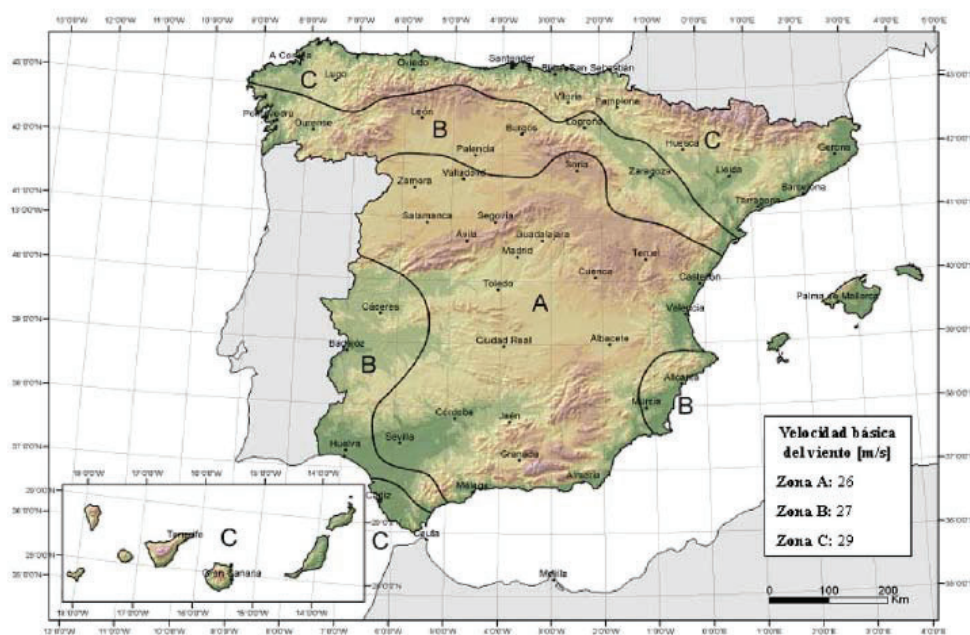
Figura D.1 Valor básico de la velocidad del viento, v_b
