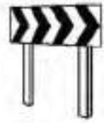
Panell fixe desviament trànsit
