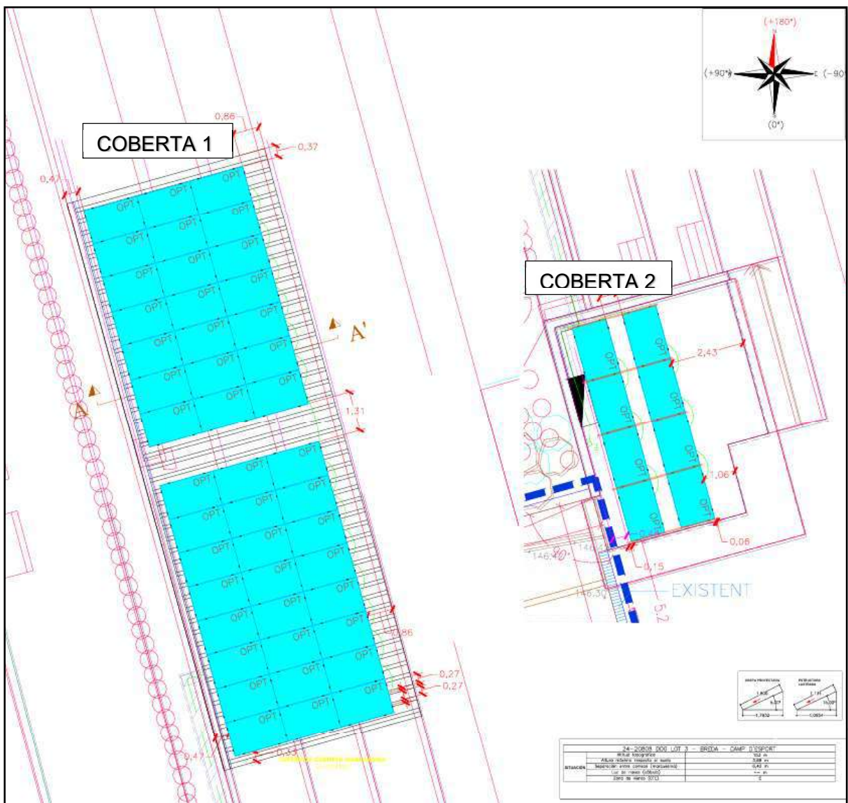
Il·lustració 3 - Detall proposta instal·lació fotovoltaica 53 mòduls de 465 Wp
