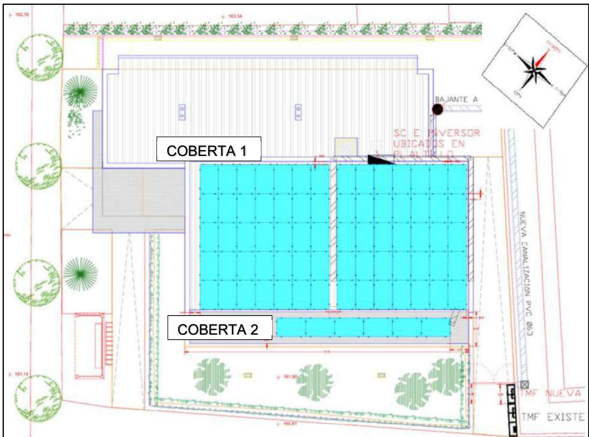
Il·lustració 3 - Detall proposta instal·lació fotovoltaica 76 mòduls de 465 Wp
