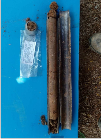
Fotografia 3. Detall dels materials recuperats a l'assaig SPT-1.
