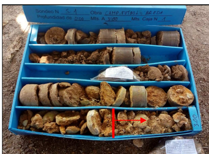
Fotografia 2. Vista dels materials recuperats en el sondeig S-1 on es poden observar els materials del primer nivell, diferenciant els dos trams anteriorment descrits.
