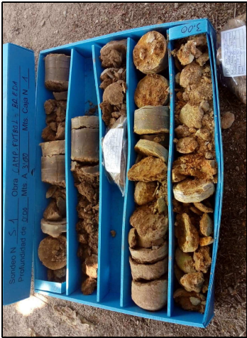
Fotografia 2. Detall de la caixa porta-testimoniis del sondeig S-1, de 0.0 a -3.0 metres.
