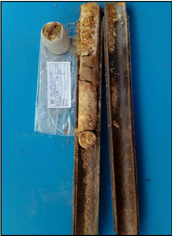
Fotografia 3. Detall dels materials recuperats a l'assaig SPT-2.
