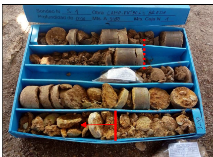
Fotografia 1. Vista dels materials recuperats en el sondeig S-1 on es poden observar els materials del primer nivell, diferenciant els dos trams anteriorment descrits.
