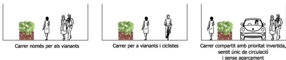
Figura 16. Possibles seccions per a carrers amb menys de 7 m d'amplada
