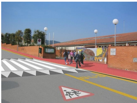
Figura 57. Fotomuntatge proposta de plataforma sobreelevada que cobreixi tot l'entorn d'accés a l'escola i que inclogui parada de transport col·lectiu i diferents elements de mobiliari urbà
