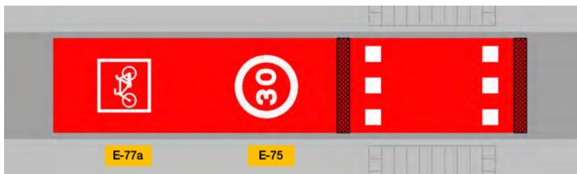
Figura 47.Exemple d'accés a carrer de zona 30: Pas de vianants elevat per reduir la velocitat dels vehicles i senyalització horitzontal
