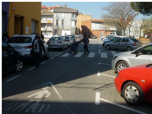
Imatge 61. Semibateria invertida a carrer del Nord.
