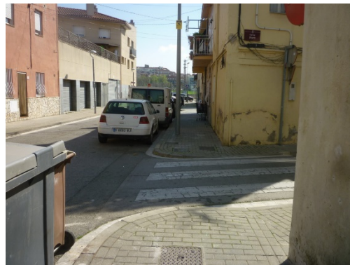
Imatge 128. El pas de vianants està ben situat, però la visibilitat està afectada pels contenidors
