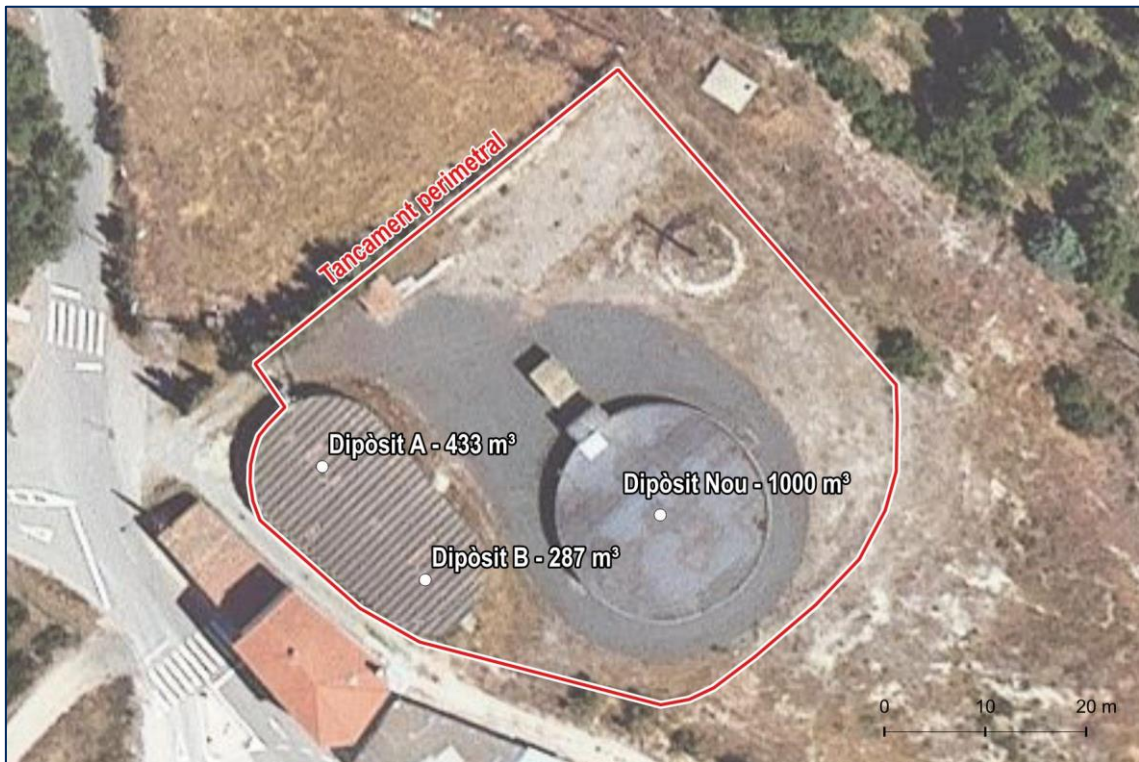
Il·lustració 10: Vista en planta del recinte on es troben els dipòsits de capçalera del municipi de Corbins.
