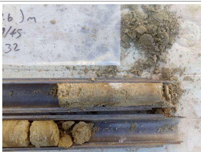
Vistes dels materials del subsòl extrets en un assaig SPT realitzat al llarg del sondeig P-3.
