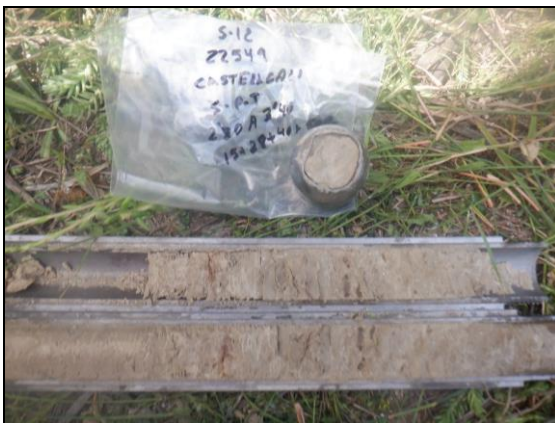
Foto 27: Sondeig S-12, SPT a 2,9 metres.
