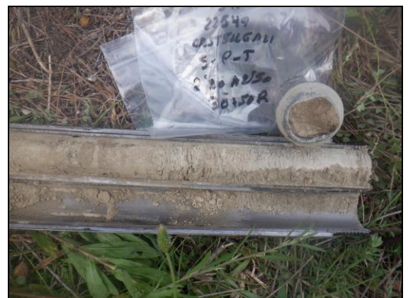
Foto 24: Sondeig S-11, SPT a 2,3 metres.
