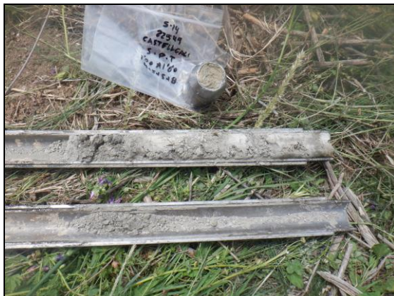
Foto 31: Sondeig S-14, SPT a 1 metre.
