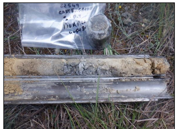
Foto 12: Sondeig S-6, SPT a 1,1 metres.
