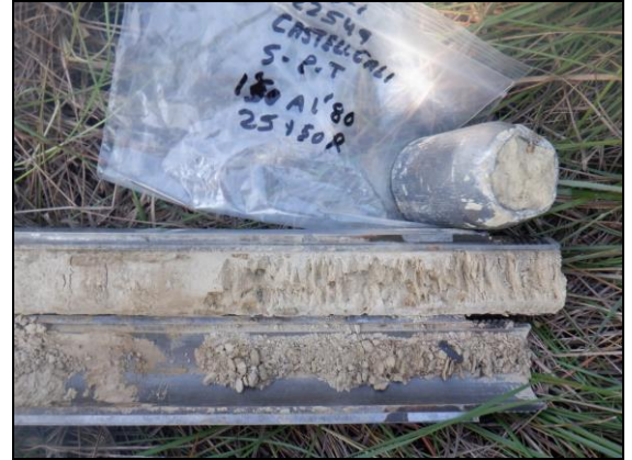
Foto 2: Sondeig S-1, SPT a 1,5 metres.
