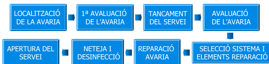
Procés associat a la reparació d'una canonada
