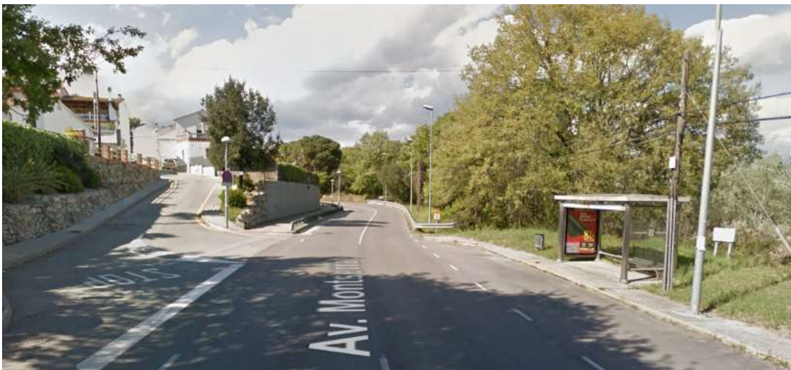
Imatge 5. Exemple de parada a Lliçà sense pas de vianants
