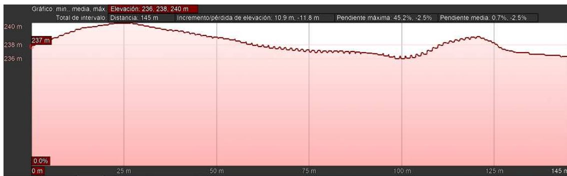
Perfil longitudinal de la nova canonada
