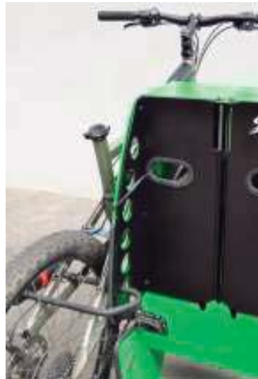
Detall bicicleta lligada i bloqueig tapa amb la protecció endoll/carregador, més seient, més casc
