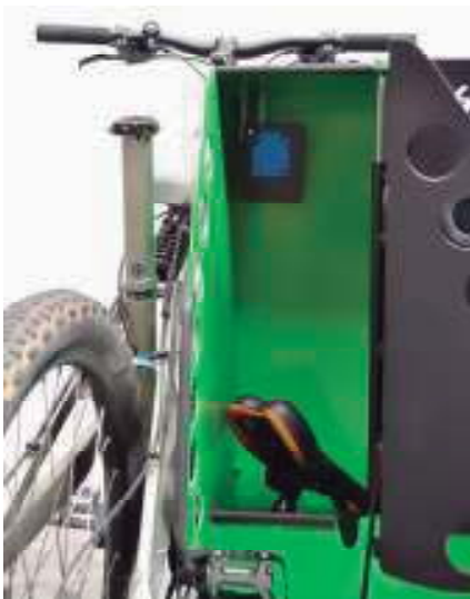
Detall allotjament bicicleta/bateria endollada més protecció seient, més casc
