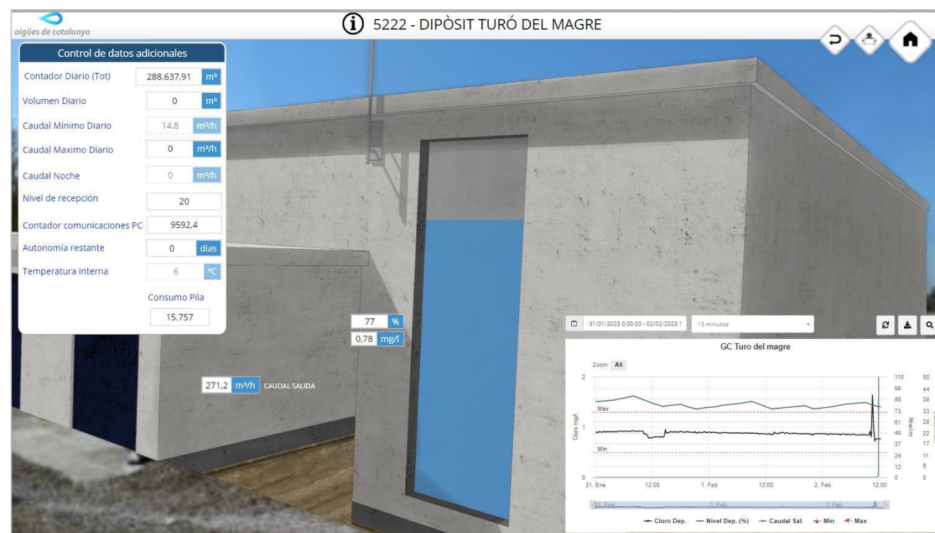
Imatge 5. Telecontrol dipòsit Turó del Magre. Font Nexus.
