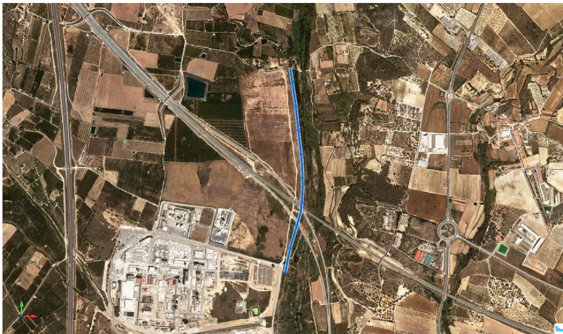
Figura 14. Ubicació en planta de l'obra de protecció (no es permet el pas d'aigua del riu cap a la plana d'inundació).
