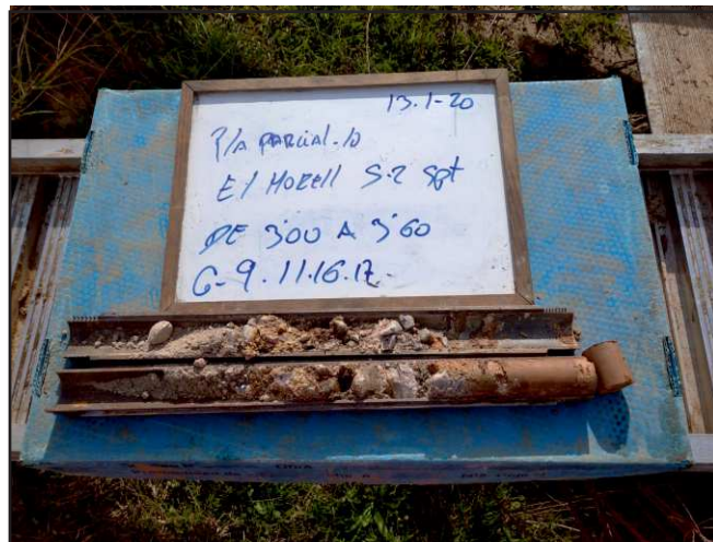
Assaig SPT realitzat al sondeig S-2 entre 3,0 i 3,6 m.
