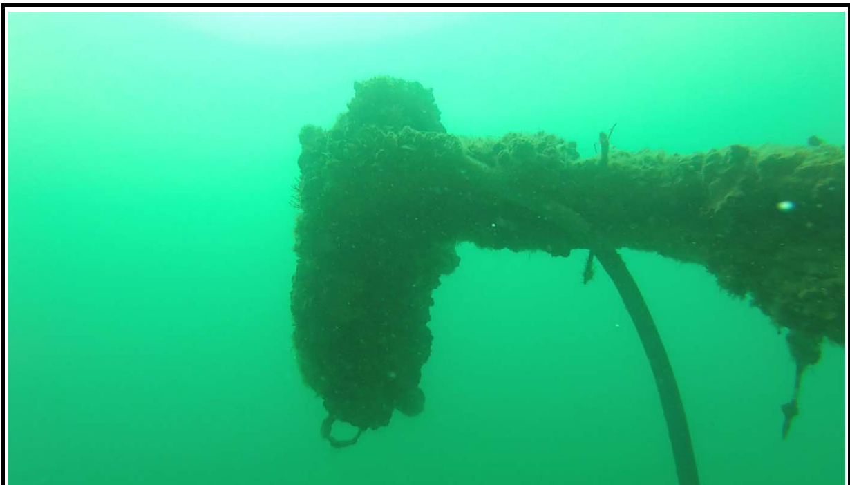
Imatge 54.- Estat actual de la colonització del suport de l'instrumental de la UPC.
