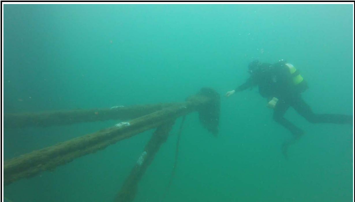
Imatge 53.- Ànodes de sacrifici dels suports de l'instrumental oceanogràfic de l'UPC.
