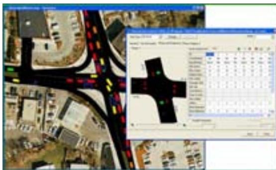
Figura 13. Exemple d'aplicació del softxare de microsimulació de trànsit Transmodeler que permet optimitzar el disseny de cruïlles i punts conflictius de la xarxa
