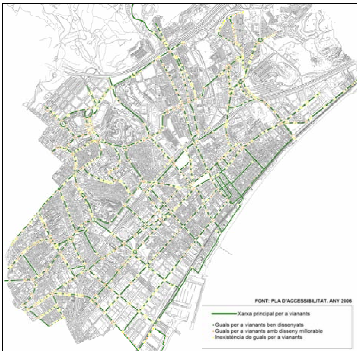
Fig. 9. Guals per a vianants de la Xarxa principal per a vianants a l'àmbit del centre urbà Font: Elaboració pròpia a partir de les dades del Pla d'Accessibilitat 2006. S'adjunta plànol a l'Annex 2
