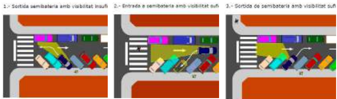
Gràfic 14. Explicació de funcionament de la semibateria inversa
