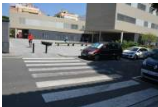
Imatge 35. Aparcament de vehicles que obstrueix la visibilitat i s'hauria de substituir per aparcament de motocicletes.
