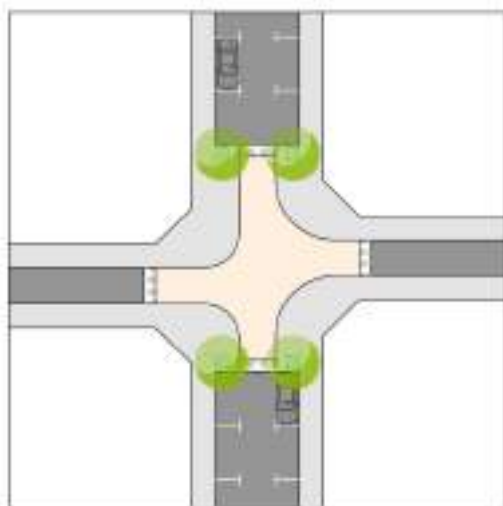
PLATAFORMA A LA CRUÏLLA Indueix a reduir la velocitat, i millora la visibilitat a la cruïlla. (Font de consulta: "Calmar el tràfic", Ministerio de Fomento, Dirección General de la Vivienda, la Arquitectura y el Urbanismo.)
