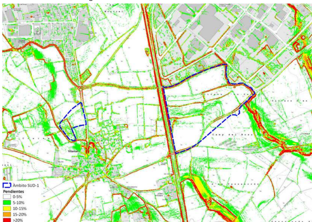
Imagen 20. Pendientes en torno al ámbito SUD-1
