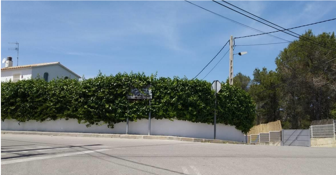
Fig. 23: Senyal d'indicació i senyal de STOP que no son correctament visibles per la vegetació; Font: AIM, elaboració pròpia
