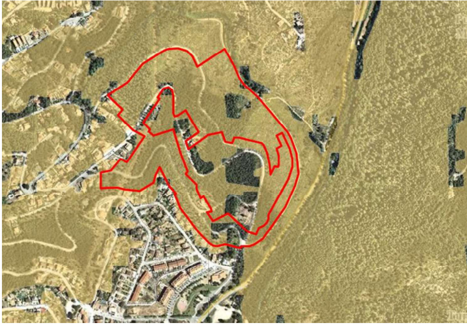
Fig. 1.2.- Mapa de pendents > 20% (ombrejat groc) amb ubicació de la zona analitzada (color vermell).
