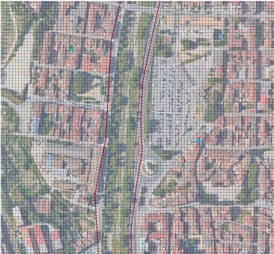
Detall d'implementació de línies de trencament i disposició resultant de cel·les
